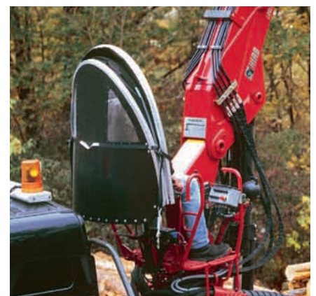
Das Dach für den hohen Fahrersitz ist an vier Punkten am Sitz angebaut.
